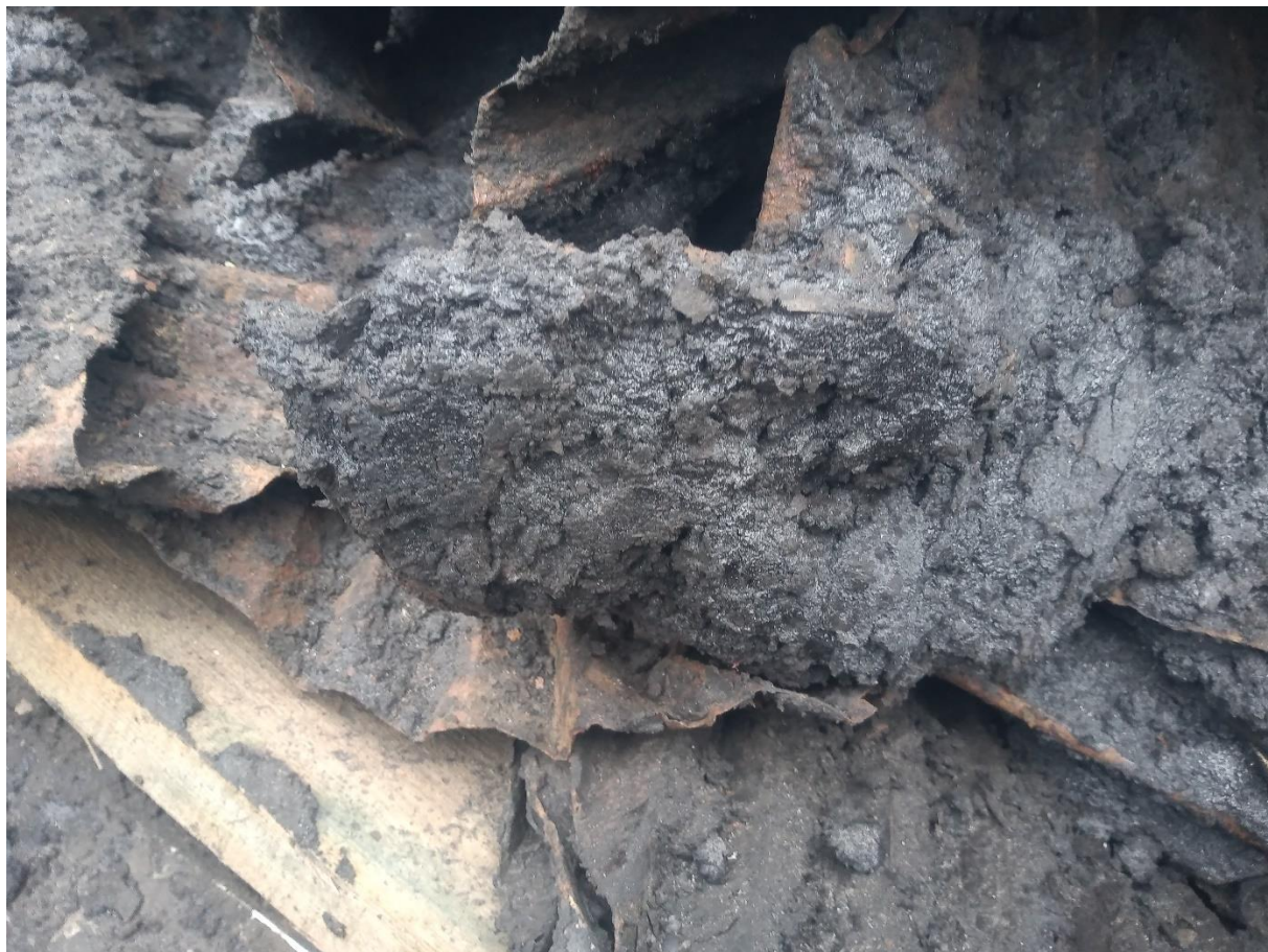
Рисунок 2.2 – Зовнішній вигляд відкладень на поверхні насадки бензольного скрубера
