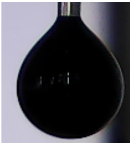
Рисунок 5.2 – Зображення краплі смоли в чистій воді (міжфазний натяг 33,3 мН/м)
