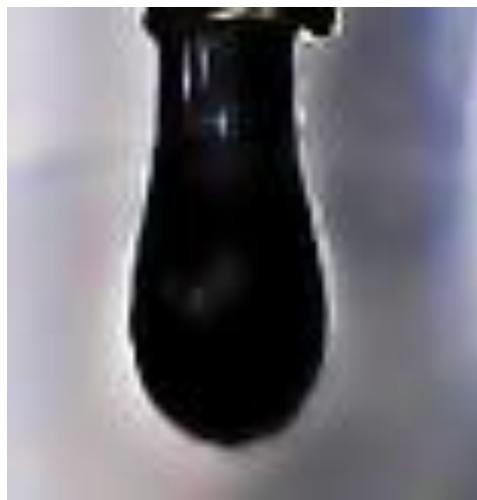
Рисунок 5.3 – Зображення краплі смоли у водорозчинному "ПМ марка А" (міжфазний натяг 0,9 мН/м)
