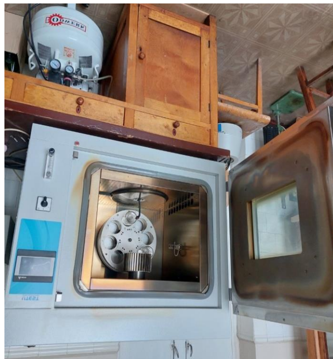
Рисунок 2.12 – Піч для старіння бітуму
