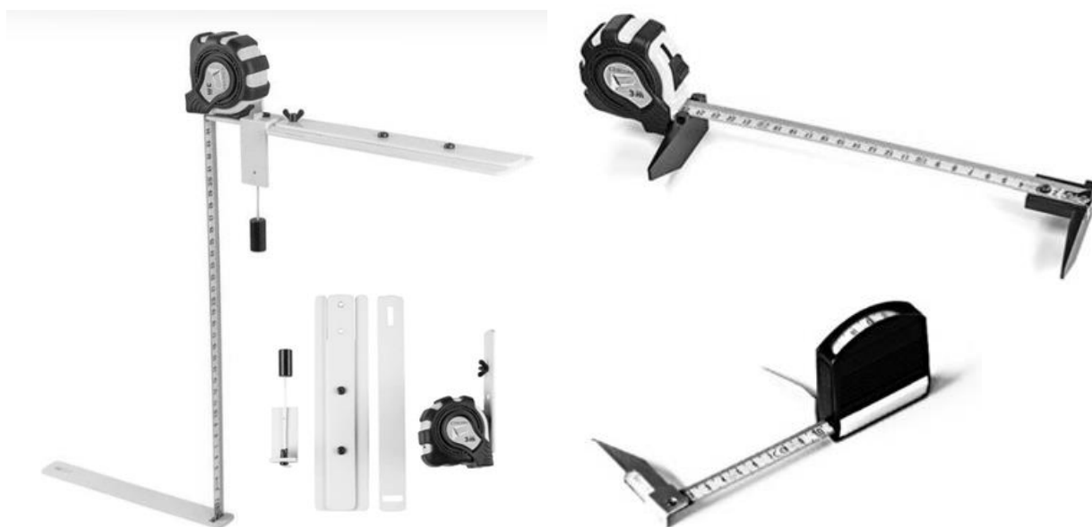
Рисунок 4.2 – Сантиметрова стрічка, градуйована в міліметрах (рулетка або сегмометр – segmometer), як антропометричний інструмент
