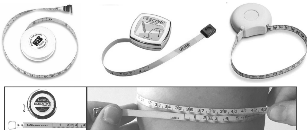
Рисунок 5.2 – Антропометричні стрічки для визначення обводових параметрів тіла
