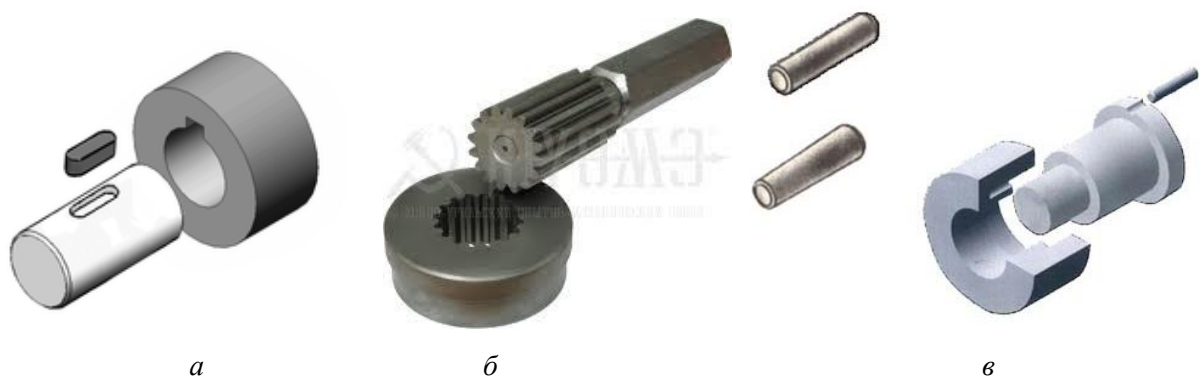
Рис. 3.54. Шпонкові (а), шліцьові (б) та штифтові (в) з'єднання
