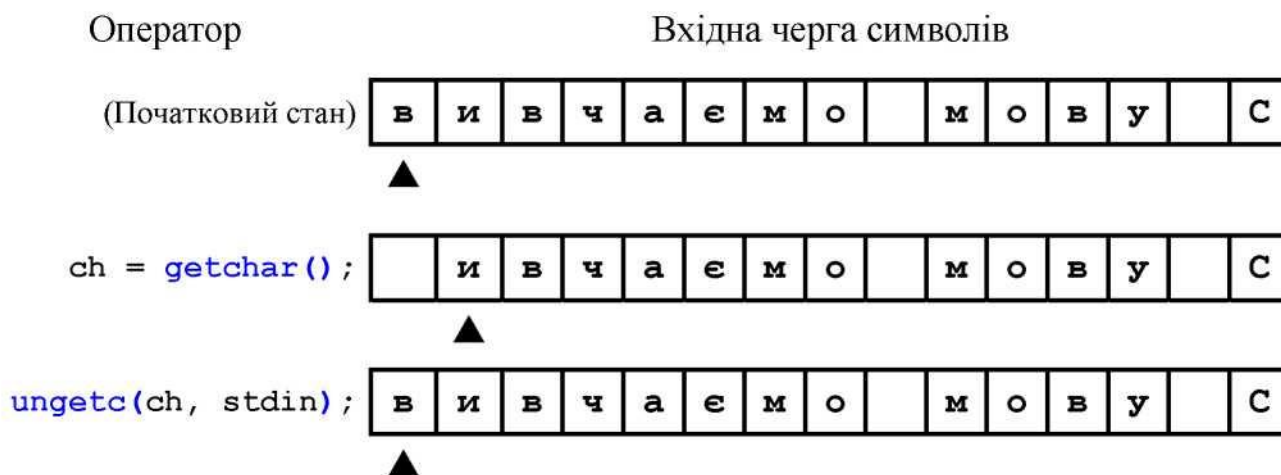
Рисунок 8.8 – Принцип роботи функції ungetc()
