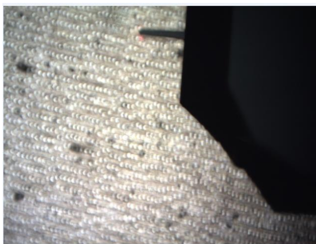
Рисунок 4.21 – Структура поверхні обробленого зразка 1 у момент сканування кантилевером мікроскопа
