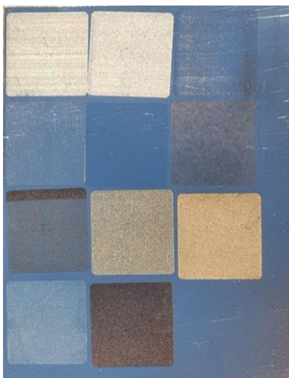
Рисунок 4.2 – Вид обробленої поверхні зразків для режимів 1-11 (табл. 4.1) при природному висвітленні
