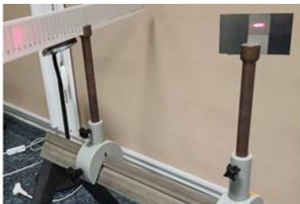
Рисунок 4.48 – Загальний вигляд процесу експериментального дослідження розсіювання випромінювання гелій-неонового лазера
