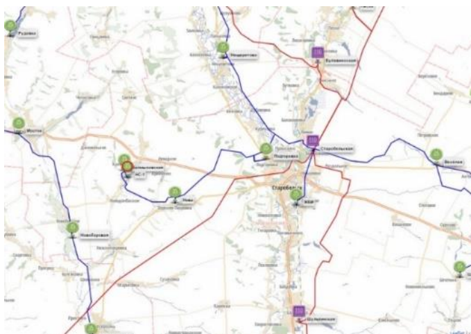
Рис. 1.13 – Розташування та основні підключення підстанції Старобільська.
