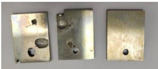
Рис. 4.12. Наскрізні пітінги в зразках сплаву ЕП1718 після випробувань на пітінгову корозію впродовж 72 годин за температурою 50 °С у розчині 10 % \text{FeCl}_3
