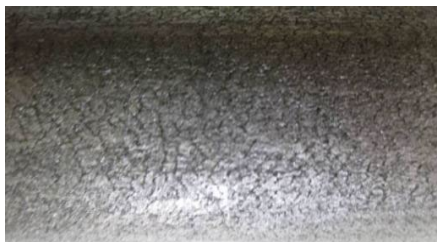
Рис. 2.72. Лускатість поверхні труб
