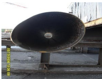
Рис. 2.74. Відхилення діаметра і підвищена овальність
