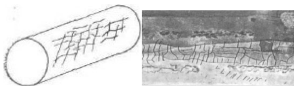
Рис. 2.96. Схема і зовнішній вигляд прутка сталі із сіткою травильних тріщин
