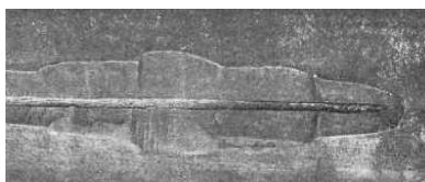
Рис. 2.22. Розкатаний і розірваний газові бульбашки
