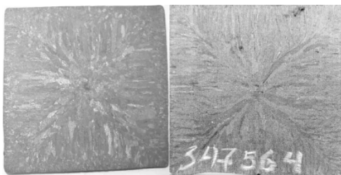
Рис. 2.15. Розвинена стовпчаста структура литої заготовки
