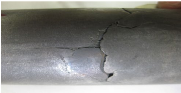
Рис. 2.79. Рваніна на поверхні холоднодеформованих труби
