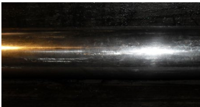
Рис. 2.77. Відбитки на зовнішній поверхні холоднодеформованих труб
