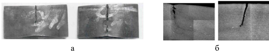
Рис. 2.87. Тріщина по ліквації (хімічній неоднорідності): а – зовнішній вигляд; б – вид в перерізі
