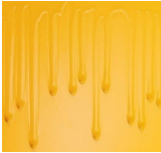
Рис. 2.100. Напливи на лакофарбовому покритті
