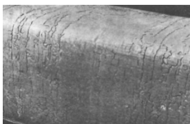
Рис. 2.22. Розкатаний і розірваний газові бульбашки
