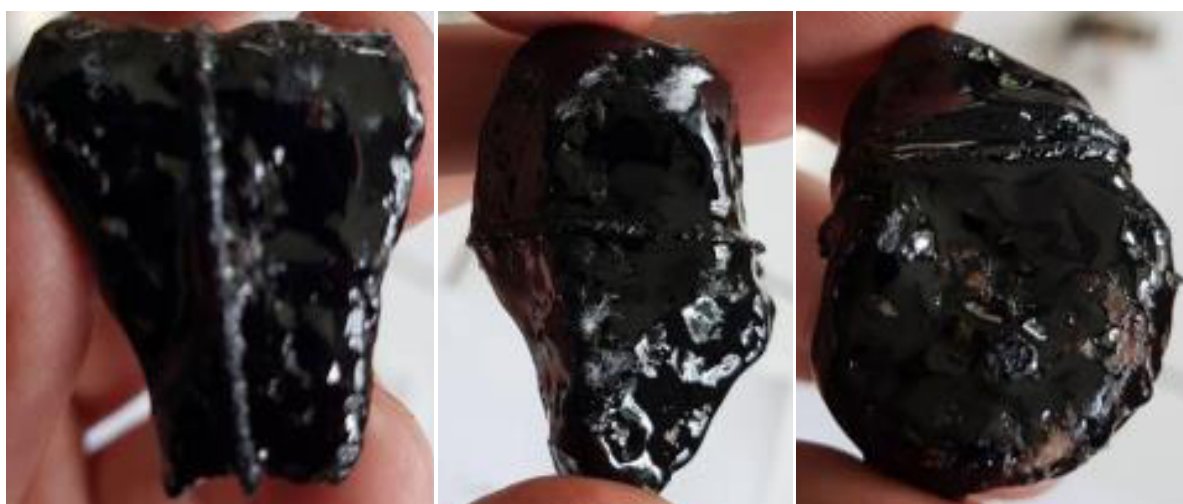
Рисунок 3.8 – Зразки №1, 2, 3 з додаванням 7 мас. % смоли бурого вугілля після термодеструкції
