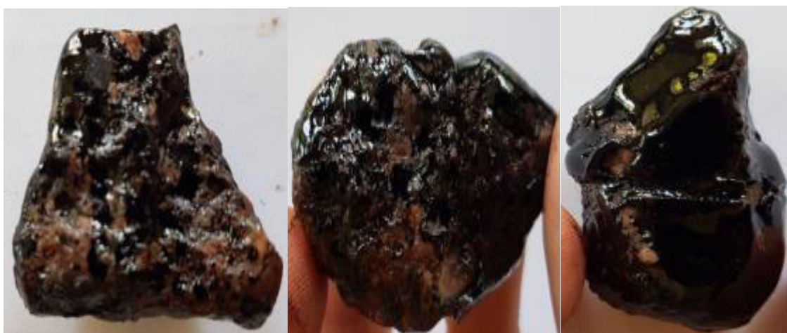
Рисунок 3.6 – Зразки №1, 2, 3 без додавання смоли бурого вугілля після термодеструкції
