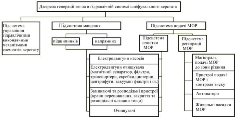
Рисунок 2.7 – Основні джерела тепла в гідравлічній системі шліфувальних верстатів
