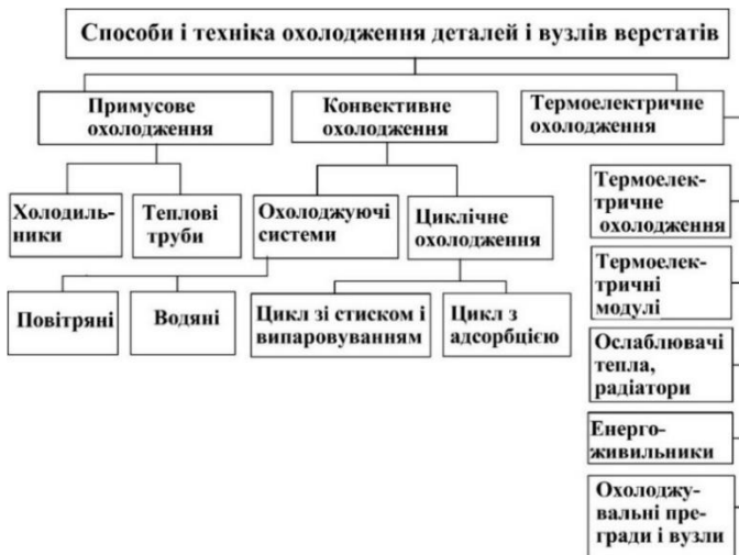
Рисунок 1.9 – Класифікація способів і техніки охолодження металорізальних верстатів
