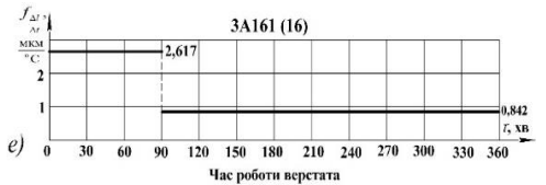
Рисунок 4.9 – Зміна параметра f_{\Delta t/\Delta t} протягом робочого дня: а-д – верстати 3Б151; е, жс – верстати 3А161; з, и – верстати 3Б161; к – верстат 3А164
