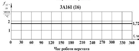
Рисунок 4.9 – Зміна параметра f_{\Delta t/\Delta t} протягом робочого дня: а-д – верстати 3Б151; е, жс – верстати 3А161; з, и – верстати 3Б161; к – верстат 3А164
