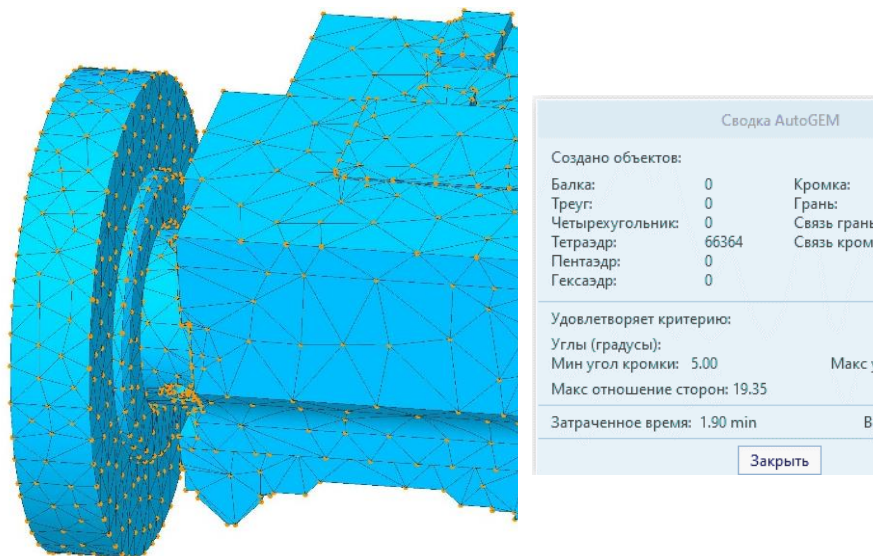
Рисунок 4.16 – Скінчено-елементна модель створена в AutoGEM
