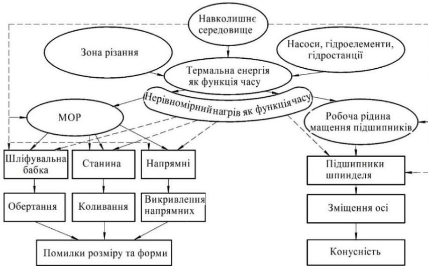
Рисунок 2.6 – Схема формування точності деталей у технологічній системі шліфування під дією змінної температури використовуваних робочих рідин
