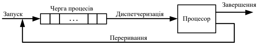
Рисунок 2.5 – Схема обслуговування черги процесів
