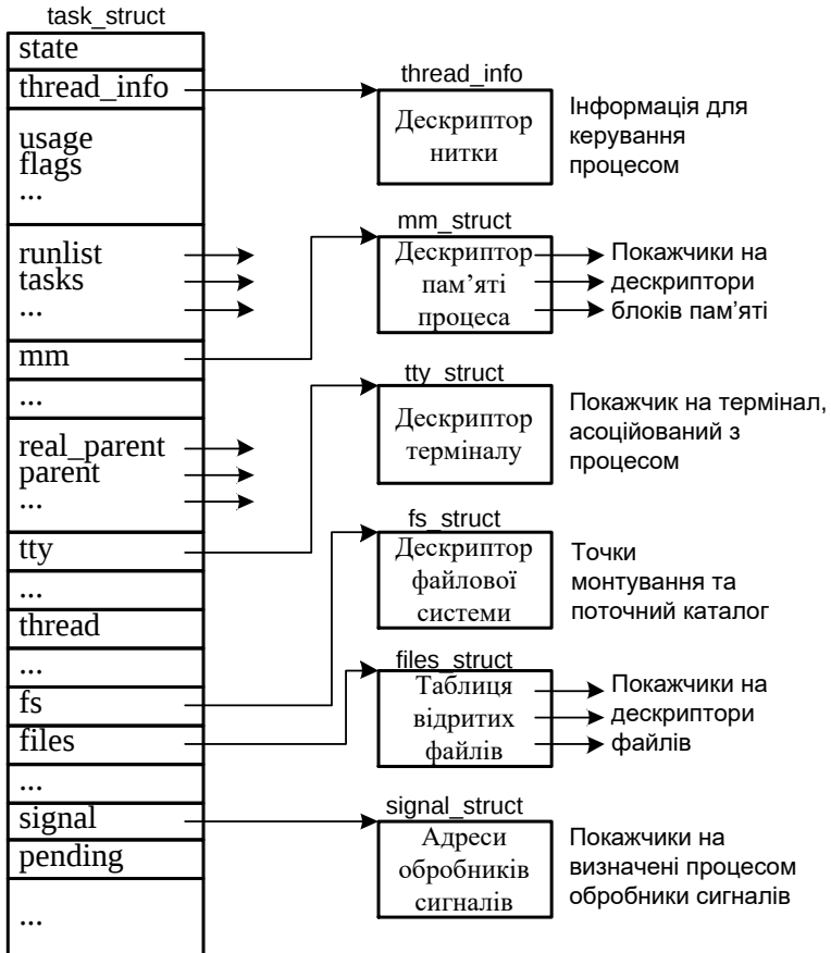
Рисунок 2.2 – Типовий БУП в ОС Linux
