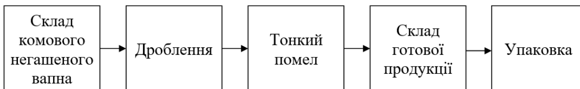
Рисунок 3.3 – Схема виробництва негашеного вапна
