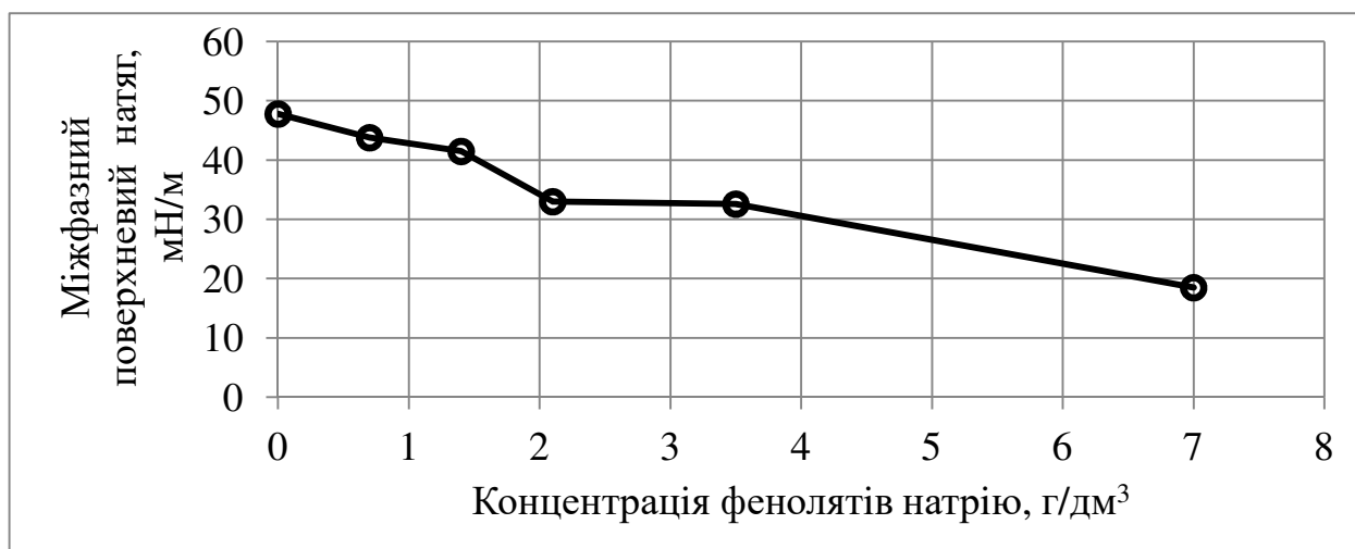
Рисунок 5.12 – Поверхневий натяг смоли, крапля якої містилася в штучний розчин фенолятів натрію
