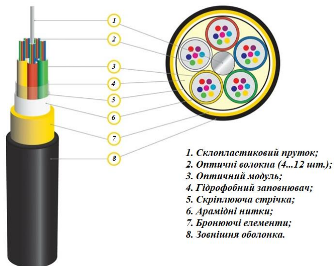
Рисунок 2.10 – Будова оптичного кабелю
