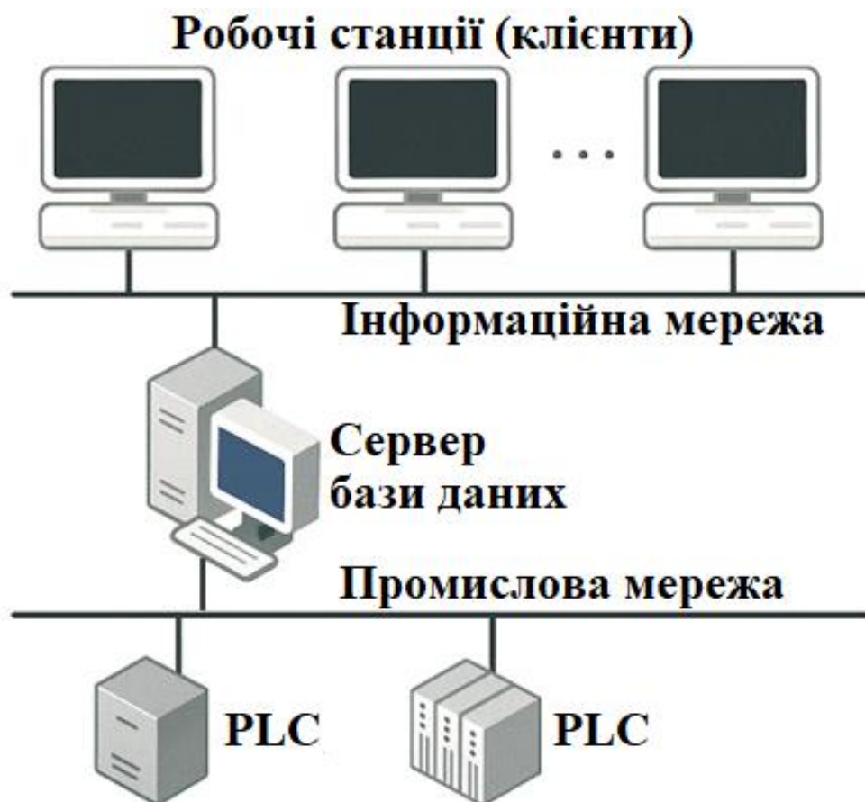
Рисунок 4.3 – Клієнт-серверна архітектура SCADA
