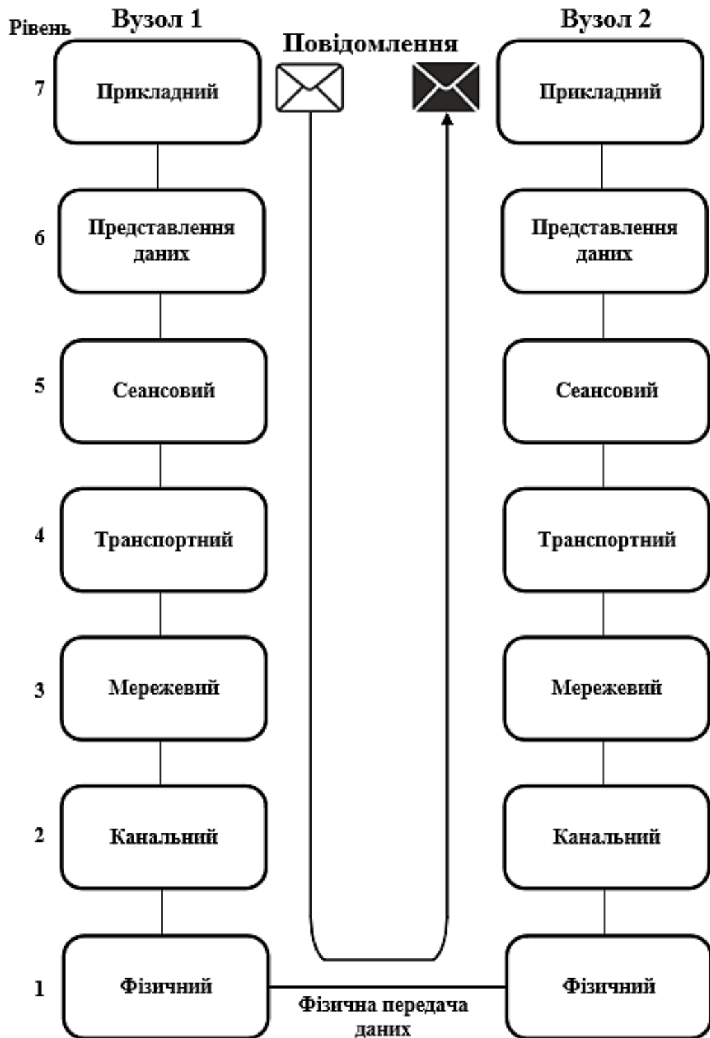
Рисунок 1.2 – Модель взаємодії відкритих систем OSI
