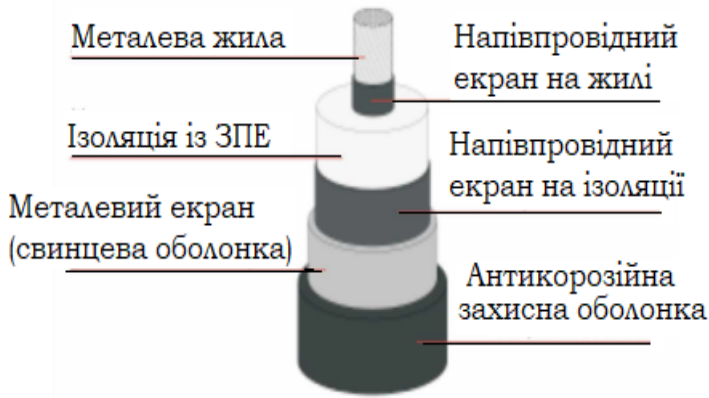
Рисунок 6.4 – Конструкція кабелю з ізоляцією зі зшитого поліетилену
