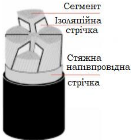
Рисунок 6.3 – Конструкція сегментованої жили типу « Milliken »
