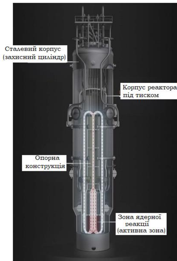
Рисунок 12.10 – Реактор американської компанії NuScale Power
