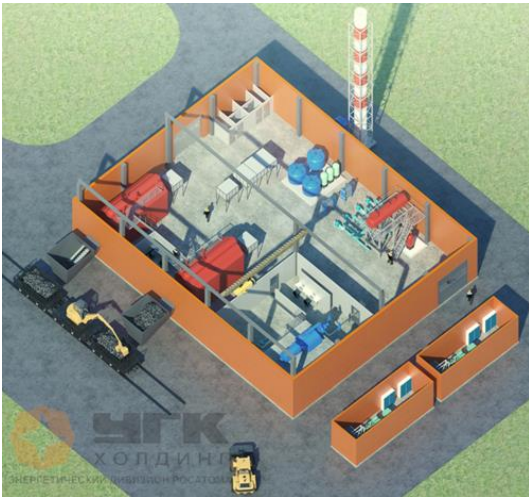
Рисунок 4.5 – Схема розташування обладнання на міні-ТЕЦ (а та б) електричною потужністю 6 МВт та вид блоку міні-ТЕЦ всередині (в)
