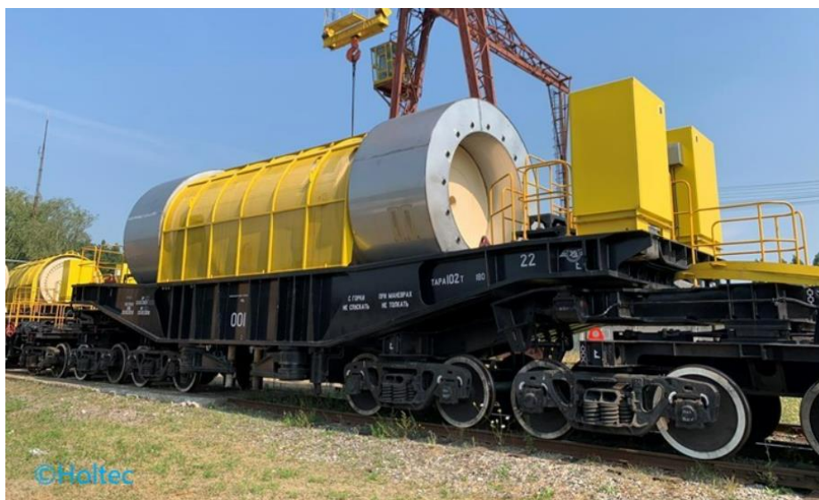
Рисунок 4.22 – Герметичний вагон-контейнер для перевезення ВЯП
