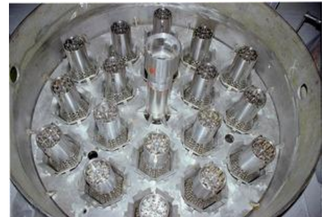
Рисунок 4.9 – Активна зона АЕС: а – реактор ВВЕР-1000 (розміри мм); б – Загальний вигляд головного корпусу АЕС з реактором ВВЕР-1000; в – ТВС, завантажена ТВЕЛ; г – кришка реактора; д – чохол, який накриває ТВС перед завантаженням в реактор (видні головки ТВЕЛ-ів, у центрі – трубка з гадолінієм) 1 – приводи системи управління та захисту; 2 – кришка реактора; 3 – корпус реактора; 4 – блок захисних труб, входні та вихідні патрубки; 5 – шахта; 6 – вигорodka активної зони; 7 – ТВС і регулюючі стрижні; 8 – реактор; 9 – турбогенератор
