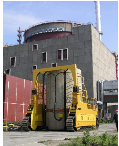
Рисунок 4.18 – Контейнер СЗВЯП та його транспортування
