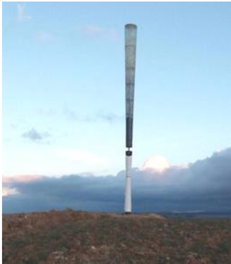
Рисунок 4.35 – Безлопатева вітряна турбіна Vortex Bladeless (фото Vortexbladeless.com )
