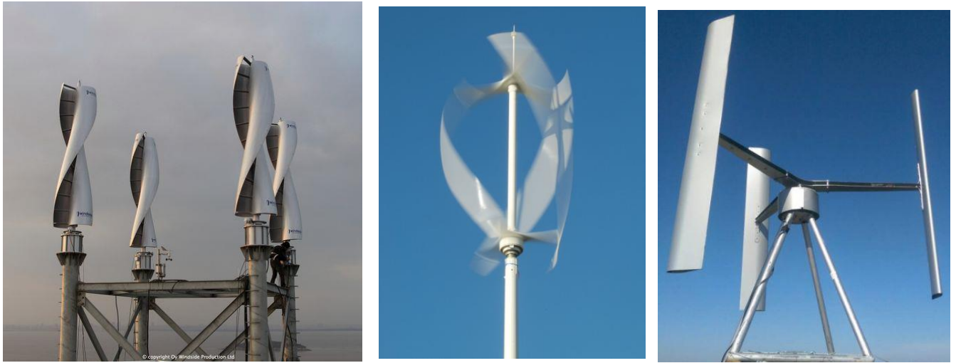
Рисунок 4.26 – ВЕУ з вертикальною віссю обертання а – ротор Савоніуса; б – ротор Ленца; в – ротор Дар'є
