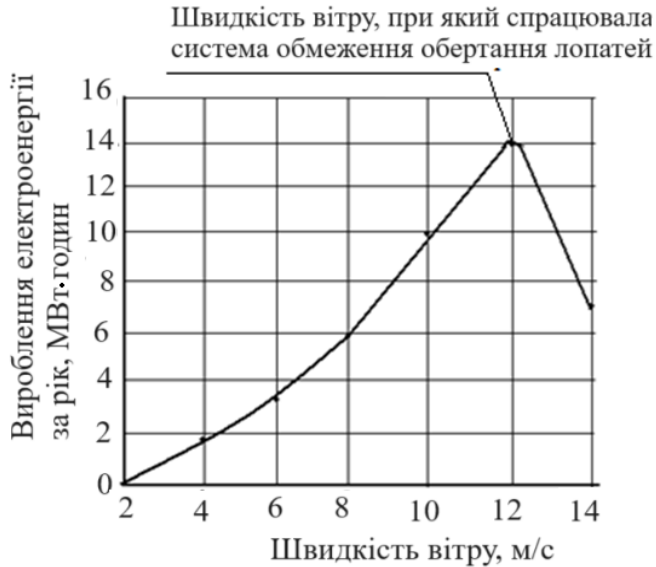
Рисунок 4.24 – Виробництво електроенергії вітро-генератором потужністю 10 кВт в залежності від середньорічної швидкості вітру (Харківська область)
