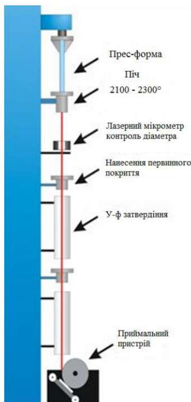
Рисунок 10.8 – Виготовлення оптичного волокна
