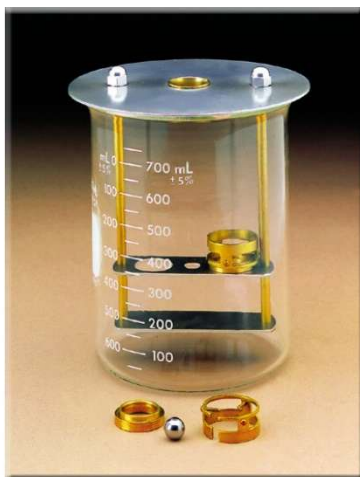
Рисунок 5.9 – Прилад для визначення температури розм'якшення матеріалів за методом «Кільце та куля»
