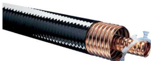
Рисунок 6.3 - Повітряний діелектричний коаксіальний кабель HELIAX для 2,7 ГГц і нижче
